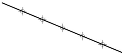
*Рис. 3.3.* Пример деление отрезка на части с использованием команды **DIVIDE (ПОДЕЛИТЬ)**
