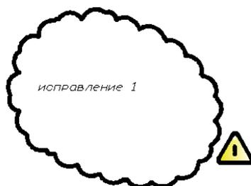
*Рис.3.31. Пример построения облака исправлений*
