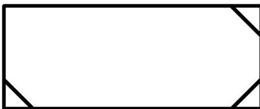
*Рис.4.32.* Пример операции снятия фаски с полилинии (использован режим **Без обрезки**)
