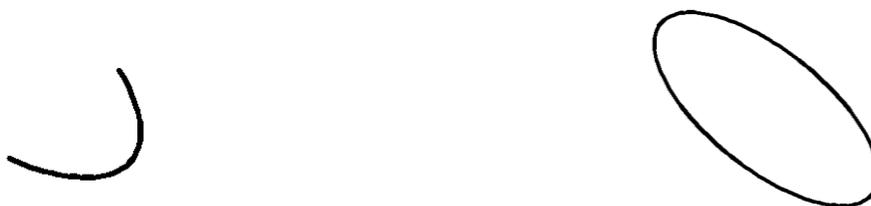
*Рис.4.28. Пример формирования эллипса из эллиптической дуги с использованием опции **Замкнуть***
