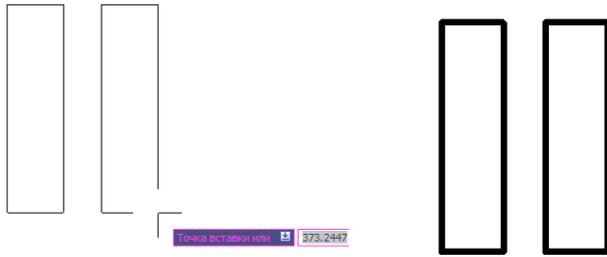
*Рис.7.5.* Пример вставки блока с указанием базовой точки, без изменения масштаба и угла поворота
