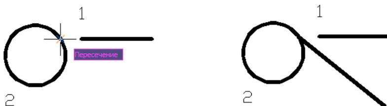
Рис. 2.13. Пример построения с привязкой к точкам **Кажущегося пересечения**
