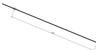
*Рис.3.4.* Разметка отрезка с помощью команды **MEASURE (РАЗМЕТИТЬ)**
